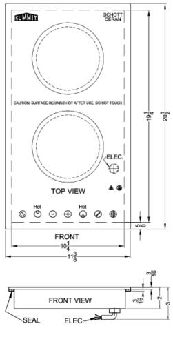
MODEL: CR2B15T1B CR2B15T2W 120V-60HZ 2400W MAX.
