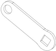
F04 LINKAGE STRAP - A4M02225 (x1) 1/8"x13/16"x2 5/8" (3x20x66)
