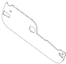
L03 LOUVER SIDE PLATE - A4M04138 (x59) 1/16"x2 3/16"x6 9/16" (2x55x167)
