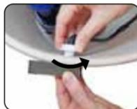
**C: ATTACHER LA CHAÎNE DU CLAPET** - Attacher la pince sur le levier de réservoir directement au-dessus du clapet. Laisser environ 1/2 po de jeu (petite forme de "J") dans la chaîne.
