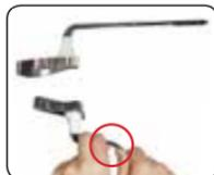
**A2: POUR MONTAGE AVANT : MESURER LE BRAS DE LEVIER** - Mesurer la longueur de l'ancien bras de levier à côté du nouveau bras de levier. Si nécessaire, découper le nouveau bras (avec une scie à métaux) au niveau de la ligne de coupe.
