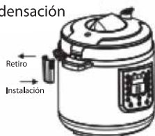
Colector de condensación
