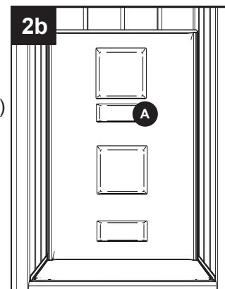
Ajuste la pared posterior para ducha (A) primero a manera de prueba. Los montantes a cada lado de la pared posterior para ducha (A) deben entrar en contacto con todo el largo de la pared posterior para ducha (A). Coloque calzas (no se incluyen) en la pared posterior para ducha (A) y los montantes según sea necesario para crear un contacto completo.
