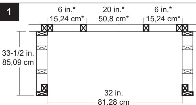
\*Specific stud spacing required for proper shelf placement/ \*Espacement de montants précis nécessaire pour permettre un positionnement adéquat des tablettes/ \*Se requiere separación específica del montante para una ubicación correcta del estante.
