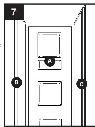
Determine y marque la ubicación de la válvula desviadora y el grifo (no se incluyen) ya sea en la pared para ducha del lado izquierdo (B) o la pared para ducha del lado derecho (C). Aplique cinta adhesiva (no se incluye) sobre las ubicaciones marcadas.
