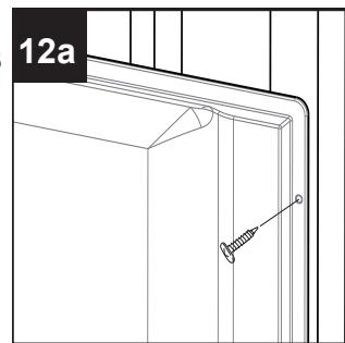
Après avoir bien positionné les panneaux, fixez les rebords avant verticaux des parois de douche gauche (B) et droite (C) à l'aide de vis de 1 5/8 po. Remarque : Poussez chaque panneau fermement vers la paroi de douche arrière (A) lorsque vous fixez les rebords afin d'assurer l'étanchéité entre les parois de douche gauche (B) et droite (C) et la paroi de douche arrière (A).
