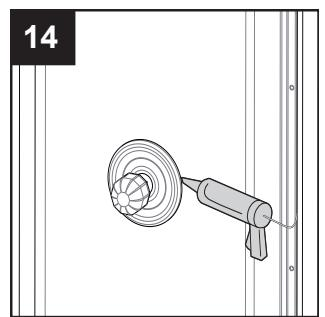
Instale y coloque masilla de calafateo (no se incluye) alrededor de los orificios en el grifo, válvula desviadora y cabezal de ducha (no se incluyen).
