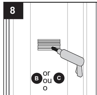
Retirez les parois de douche gauche (B) et droite (C), puis percez ou sciez les trous nécessaires. Remarque : Percez ou sciez les trous sur le devant des panneaux, où est installé le ruban-cache. Après avoir percé les trous, retirez la pellicule protectrice autour du périmètre de la baignoire et de chaque panneau.
