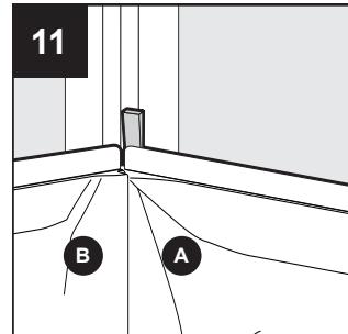
Au besoin, replacez les cales afin que les parois de douche gauche (B) et droite (C) soient bien alignées sur le devant de la baignoire et que les cales entre les panneaux soient bien serrées.
