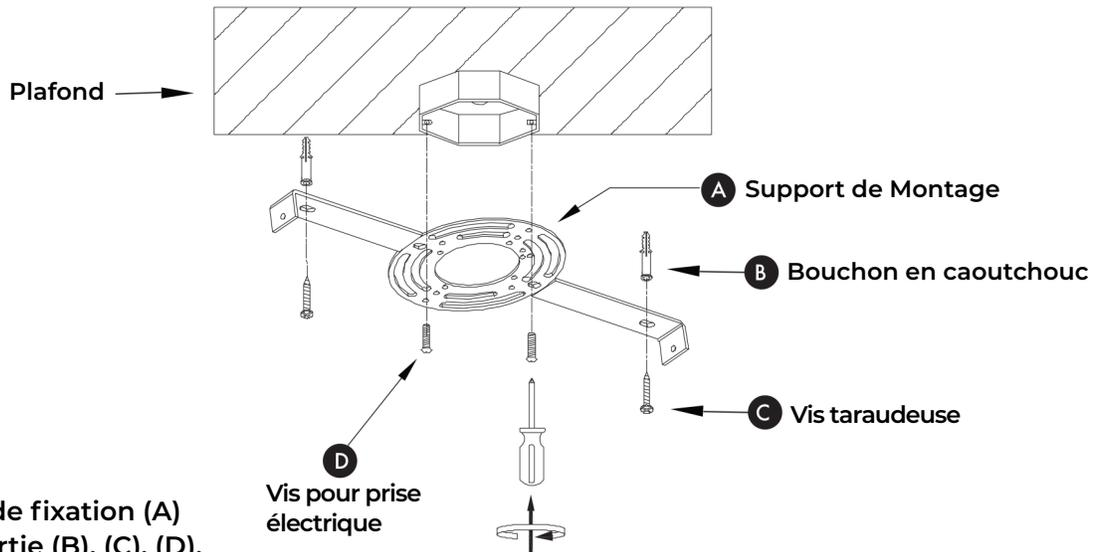
Fixez le support de fixation (A) avec les vis de sortie (B), (C), (D).
