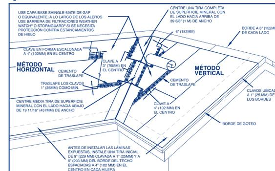
El Techado en Rollo Mineral Guard® se puede instalar siguiendo o bien el Método Horizontal (paralelo a los aleros) o el Método Vertical (paralelo a los bordes de inclinación). (Ver Figura 1)
