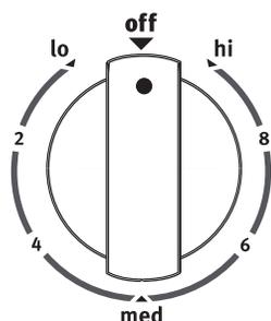
Les boutons de commande peuvent être réglés sur n'importe quelle position entre Hi (élevé) et Lo (bas). Pousser et tourner le bouton jusqu'au réglage choisi.
