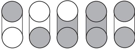
Utiliser la zone de liaison pour obtenir le chauffage d'une zone de forme allongée pour une cuisson avec un ustensile de cuisson de grande taille.
