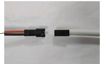
Insérer le connecteur dans la borne, puis mettre le connecteur dans le trou gauche, laisser le fil blanc à l'extérieur.
