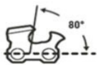
ÁNGULO CORRECTO DE LIMADO DE LA PLACA LATERAL
