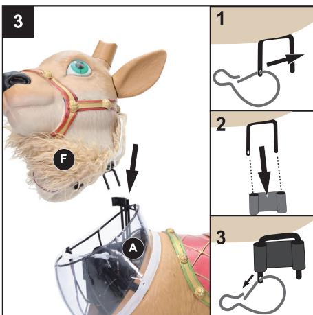
4. Retire el pasador de chaveta de la clavija disponible en la parte inferior del cuerpo (F), como se muestra en la Figura 4.1. Conecte la clavija al brazo de engranajes disponible en la caja de engranajes disponible en el cuerpo (A), como se muestra en la Figura 4.2. Luego vuelva a insertar el pasador de chaveta en la clavija, como se muestra en la Figura 4.3.
