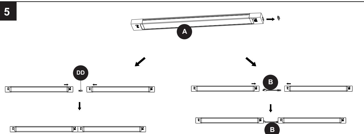
Remove the silicone stopper next to the switch if installed in series./Retire el tope de silicona junto al interruptor si está instalado en serie.
