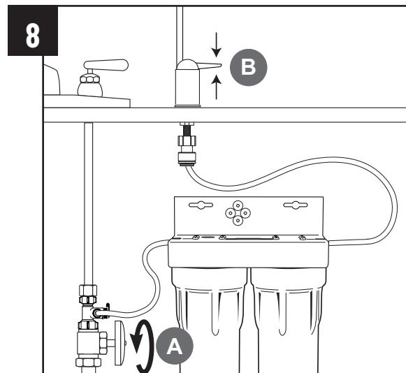
**NOTA:** La llave de agua potable se puede operar al empujar la manivela hacia abajo para llenar un vaso. Tire de la manivela hacia arriba para fijarla en esa posición para llenar recipientes más grandes.
