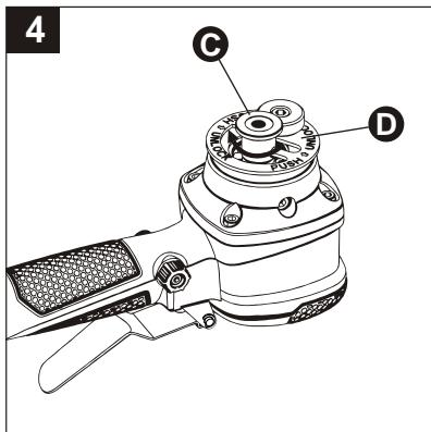
5. Empuje la placa de fijación (D) hacia adelante para que el lado acanalado de la placa de fijación (D) quede en el orificio del alojamiento del rodamiento (C). Esto garantiza que el alojamiento del rodamiento (C) quede fijo y estable.
