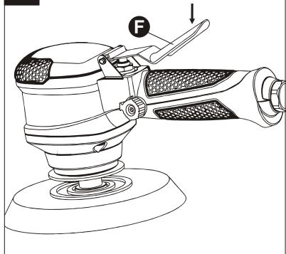
**REMARQUE** Cet outil comprend un bouton (E) du régulateur de débit d'air (E) permettant de régler la vitesse de l'outil, simplement en tournant le bouton (E). La vitesse maximale est atteinte lorsque la ligne concave du bouton (E) est à l'horizontale (consultez la figure 2).
