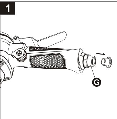
2. Agregue cinta selladora para roscas (no se incluye) a las roscas del conector macho (no se incluye), luego inserte el conector macho a mano en la entrada de aire (G). Apriete el conector macho girándolo en dirección de las manecillas del reloj con una llave de tuercas (no se incluye). NO APRIETE DEMASIADO.
