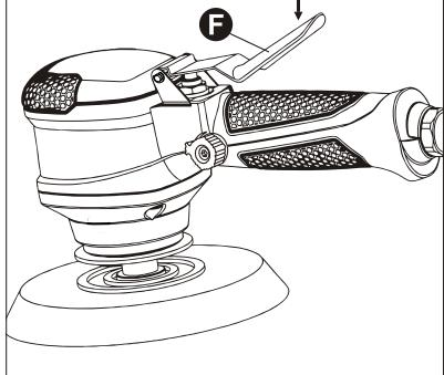
**NOTA** La herramienta cuenta con una perilla reguladora de aire (E). La velocidad de la herramienta se puede ajustar girando la perilla reguladora de aire (E) ya sea en dirección de las manecillas del reloj o viceversa. La velocidad máxima de la herramienta se puede obtener cuando la línea cóncava de la perilla (E) está en posición horizontal (Consulte la Figura 2).
