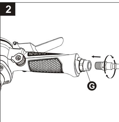
3. Coloque de 2 a 3 gotas de aceite para herramientas neumáticas (no se incluye) en el conector macho antes de cada uso.
