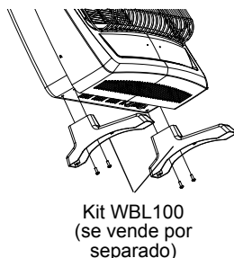
Fig. 13: colocación de las patas
