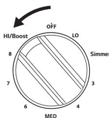
La durée maximale de fonctionnement pour tous les niveaux d'éléments à l'exception du mode Boost est de 12 heures.
