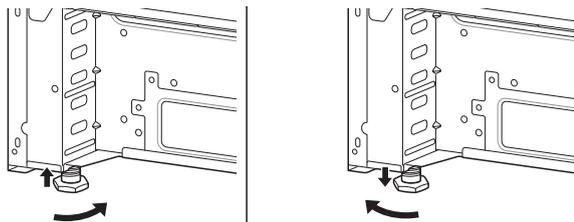
Utilisez un niveau pour vérifier les réglages. Placez le niveau en diagonale sur la grille du four pour vérifier le niveau dans chaque sens.
