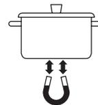
Pour une cuisson optimale, utilisez uniquement des casseroles à fond d'acier épais sur les éléments de cuisson à induction. Suivez les recommandations du fabricant lorsque vous utilisez des casseroles à induction.
