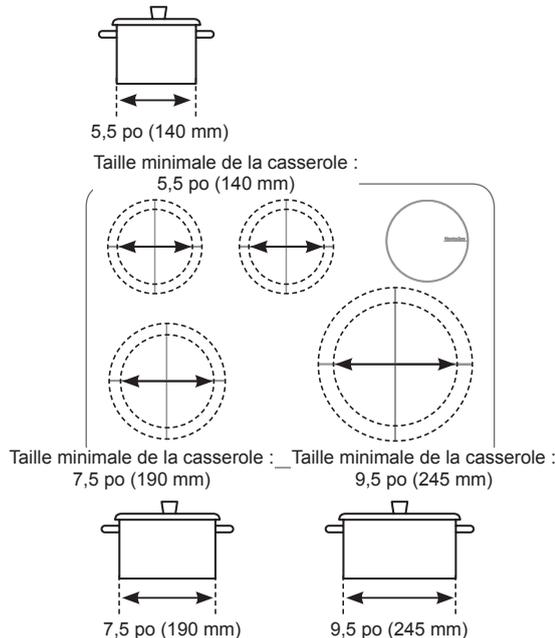
Utilisez la croix marquant chaque élément de cuisson pour déterminer la taille maximale de casserole. Lorsque la casserole est placée au centre de l'élément de cuisson, elle ne devrait pas dépasser l'extrémité de la croix de l'élément de plus de 1/2 po (1,5 cm). Le fond de la casserole doit être entièrement en contact avec la surface en verre, mais il ne doit pas toucher le rebord en métal de la cuisinière.
