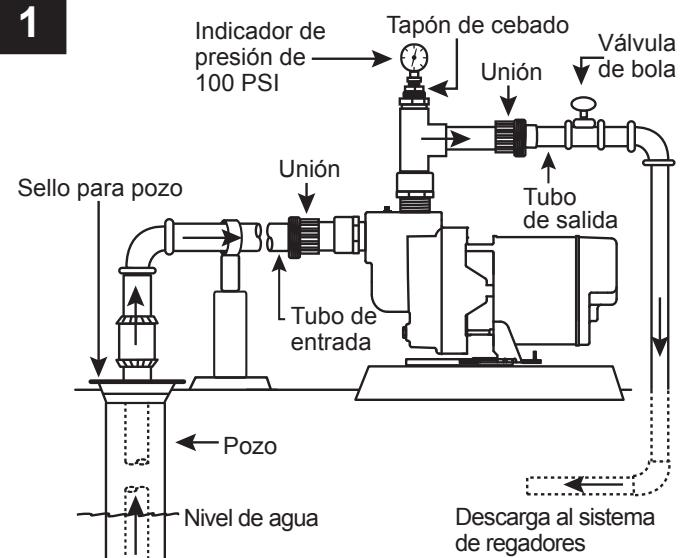
2. Una con adhesivo la unión hembra de 2 pulgadas (no se incluye) al extremo de la tubería de entrada que sale de la fuente de agua.
