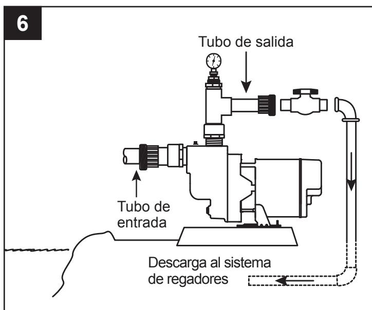
7. Conecte la unión para asegurar un ajuste adecuado. No apriete hasta después de haber cebado.
