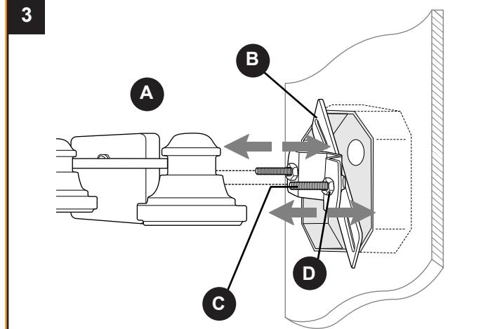
Placez temporairement A sur B. Ajustez C à la longueur appropriée, puis serrez D jusqu'à ce que D touche B. Mettez A de côté.
