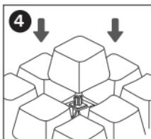
Ajustez le capuchon de touche avec la tige de l'interrupteur et appuyez pour l'insérer.
