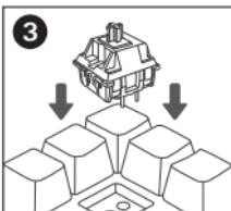
Seleccione un switch y examine los contactos de cobre ubicados en la parte inferior de dicho switch para asegurarse de que estén rectos. Alinee los contactos de cobre con las tomas de la plataforma. Inserte presionando hacia abajo.
