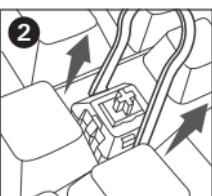
使用「鍵軸」拔鍵器夾住軸體兩側的兩個卡榫中。夾住後，向上拉，從鍵盤中移除軸體。
