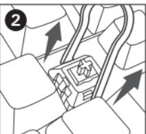
Utilice el extractor de switches para empujar las dos pestañas ubicadas a ambos lados del interruptor. Una vez empujadas, tire hacia arriba para quitar el switch de la placa.
