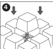
Ajuste la tecla con el switch correspondiente y presione hacia abajo para insertarla.
