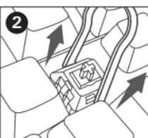
Используйте выталкиватель кнопочных переключателей, чтобы нажать на две защелки, расположенные по обеим сторонам переключателя. После нажатия потяните вверх, чтобы снять переключатель с платы.
