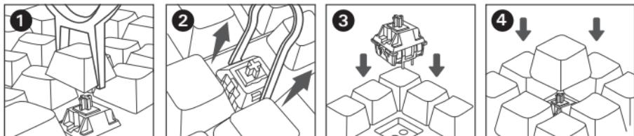
付属のキーキャップ引き抜きツールを使用し、キーキャップを上へ引き上げて引き抜きます。ある出っ張りを押し込みます。押し込み後、上へ引き上げ基板からスイッチを引き抜きます。
