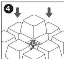
Klemmen Sie mit dem Abziehwerkzeug eine Tastenkappe ein und ziehen Sie das Werkzeug zum Entfernen der Tastenkappe nach oben.
