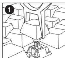
Используйте выталкиватель колпачков, чтобы зажать колпачок и снять его, потянув вверх.
