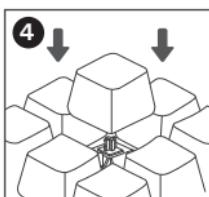
Отрегулируйте колпачок с помощью стержня переключателя и нажмите для вставки.
