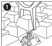
Utilice el extractor de teclas para sujetar una tecla y tire hacia arriba.
