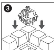
選擇軸體並檢查軸體底部的銅針，以確保它們是直的。將銅針與鍵盤墊上的插座對齊。直接向下插入。
