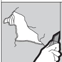
Corte una sección de un panel de pared de mayor tamaño que el agujero. Coloque el panel de pared sobre el agujero y trace el contorno del panel de pared en la pared. Utilice un serrucho o cuchillo de uso general para recortar la sección contorneada. Remueva los fiadores viejos.
