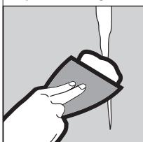
Recorte todo material suelto y límpie. Aplique compuesto en la grieta usando la espátula de acabado de 6 pulgadas.
