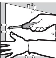
Inserte una nueva sección de pared de yeso en el área que se removió de la pared existente. Coloque fiadores a aprox. 3/4 pulgada del borde y centrados entre las lengüetas. Esto alineará los fiadores con las perforaciones en los sujetadores. Atornille a través de la nueva sección de pared de yeso y en cada sujetador de reparación de pared de yeso.
