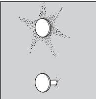
Para reparar un fiador sobre salido, inserte un fiador nuevo a 1-1/2 pulgada del fiador sobre salido. Rellene con compuesto para juntas usando una espátula. Deje que se endurezca. Añada una segunda capa de ser necesario. Lije y apreste cuando se seque.
