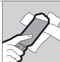
Acomode de manera cruzada dos o tres tiras de cinta para juntas sobre la abertura y embeba la cinta en el compuesto para juntas. Deje que se endurezca.
