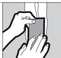
Embeba la cinta en el compuesto para cubrir la grieta. Pase firmemente la espátula sobre la grieta para embeber la cinta de manera ajustada. Deje que el compuesto se endurezca.
