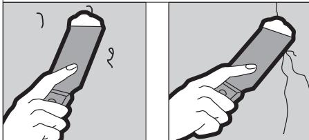
Para reparar una abolladura en una superficie pintada, lije el área alrededor de la abolladura y luego rellénela con compuesto para juntas. Deje que se endurezca. Añada una segunda capa de ser necesario. Lije y apreste cuando se seque.
