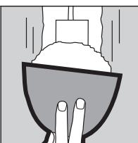
Aplique compuesto sobre la cinta usando una espátula. Deje que se endurezca y luego aplique una segunda capa de compuesto, si es necesario. Lije y apreste cuando se seque.
