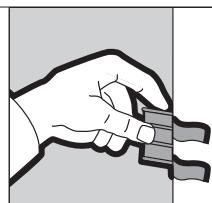
Coloque sujetadores de reparación de paredes de yeso en el borde de la abertura del panel de pared.
