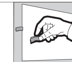
Retire las lengüetas de cada sujetador de reparación de pared de yeso. Aplique compuesto y cinta en todos los lados de la sección. No superponga la cinta.
