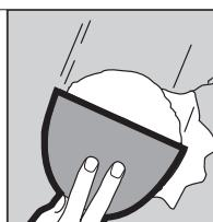
Aplique una capa delgada del compuesto para juntas con una espátula de acabado para juntas al área dañada y extienda la capa hasta lograr un acabado uniforme. Deje secar y aplique una segunda capa de ser necesario. Lije y apreste cuando se seque.
