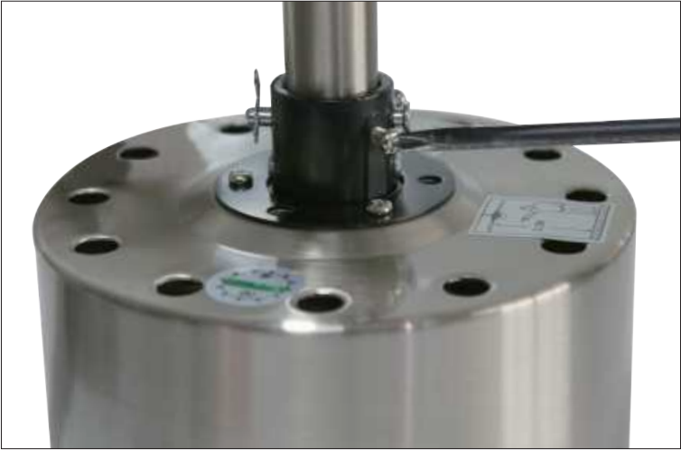
Paso 8 Aprieta los dos tornillos del acoplador.
