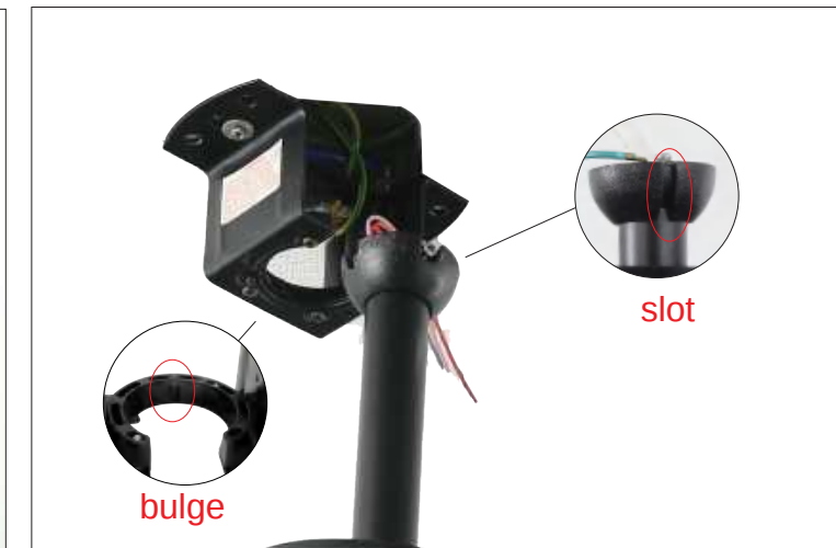
Paso 11 Cuelgue el ventilador en el soporte de suspensión y alinee la ranura de la varilla inferior con la protuberancia del soporte de suspensión.
