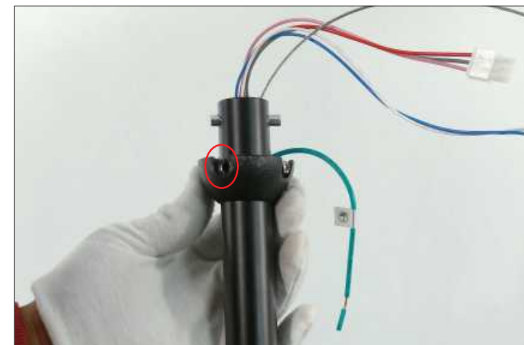
Paso 9 Empuje la semiesfera hacia arriba y deje caer la varilla corta en la ranura de la semiesfera.
