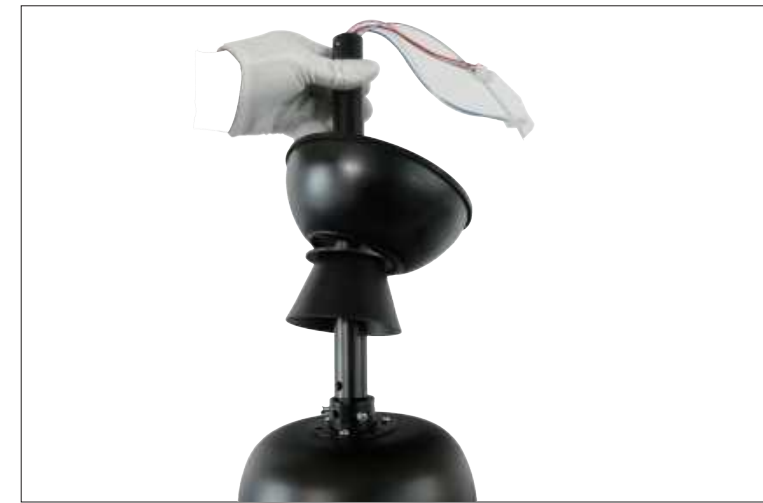
Paso 7 Pase los cables del motor y el cable metálico a través del poste.
