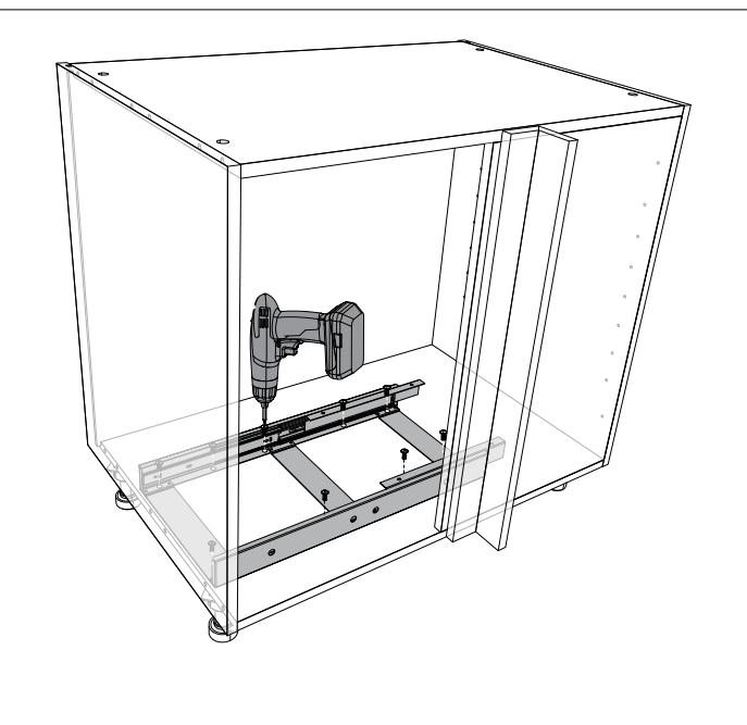
6 Insérez l'assemblage du bâti supérieur et alignez les trous de support avec les trous dans la base coulissante. À l'aide d'un tournevis ou d'une perceuse sans fil, fixez l'assemblage du bâti supérieur à l'aide de huit vis M5x8 comprises avec l'assemblage.
