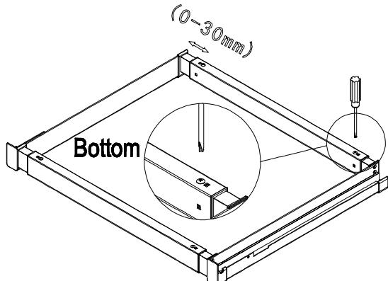
**5** Insérez la glissière et alignez les trous avec les trous percés dans l'armoire. À l'aide d'une perceuse ou d'un tournevis, fixez la glissière latérale sur l'armoire avec quatre vis de M5x16 mm.
