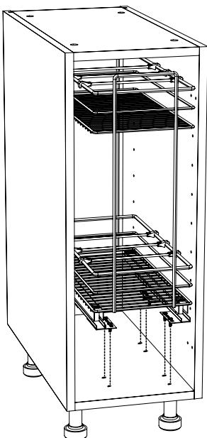
**5** À l'aide d'un tournevis ou d'une perceuse sans fil, fixez l'assemblage du panier à l'aide de huit vis M5x16 mm comprises avec l'assemblage de panier.
