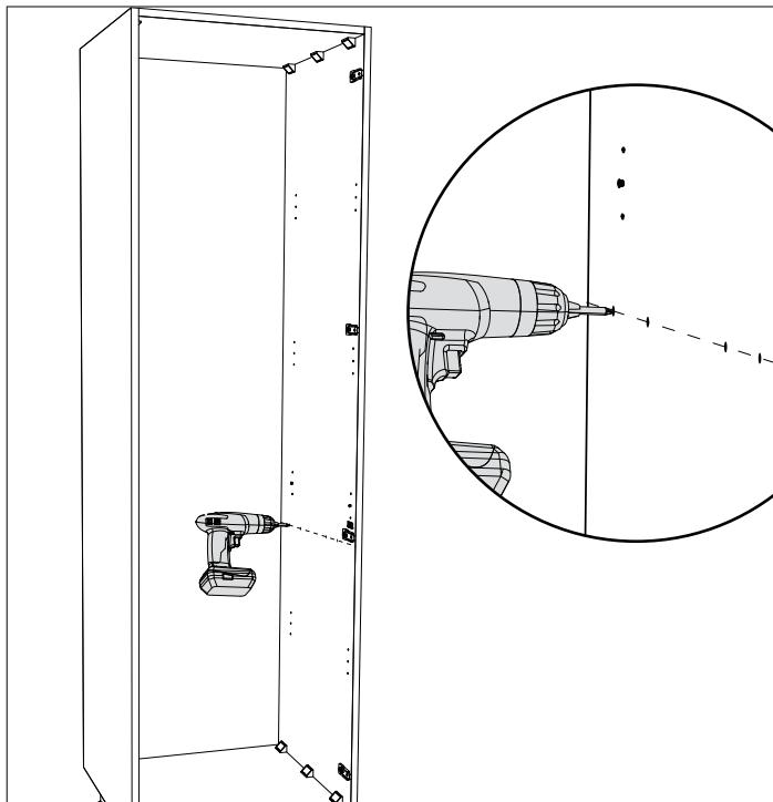
**5** Insérez la glissière et alignez les trous avec les trous percés dans l'armoire. À l'aide d'une perceuse ou d'un tournevis, fixez la glissière latérale sur l'armoire avec quatre vis de M5x16 mm.
