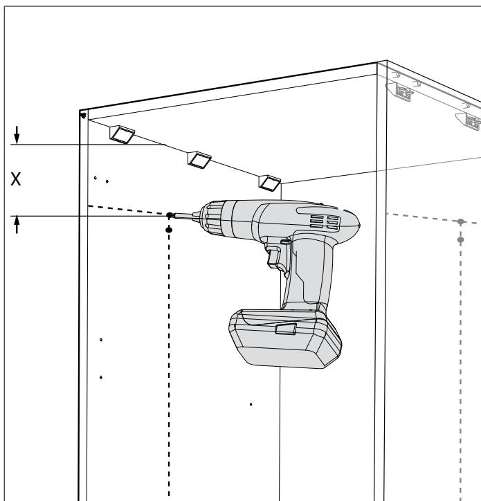
**3** Fixez un support de montage sur un côté de l'armoire avec des vis de 5x26 mm.
