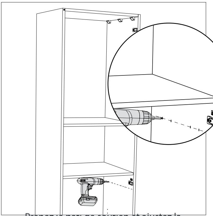
Prenez le bâti de soutien et ajustez la longueur du bâti en ajustant les vis à la base conformément à l'intérieur de l'armoire. Assurez-vous d'ajuster la distance des quatre côtés du bâti de façon cohérente.
