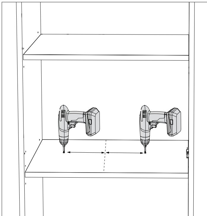
**1** Tracez une ligne centrale sur la tablette et marquez deux trous à une distance de 16,25 po pour la tringle de 18 po et de 22,25 po pour la tringle de 24 po à partir du centre des deux côtés.
