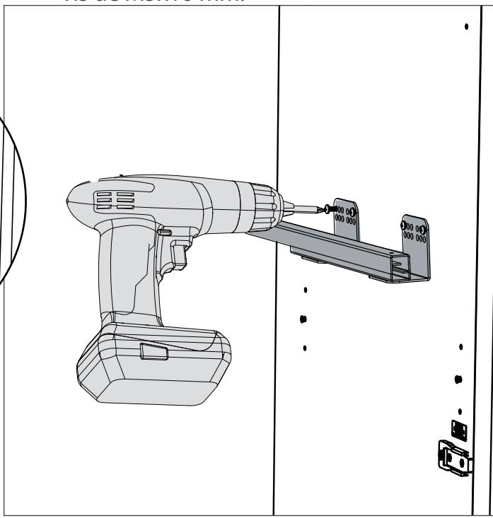
**6** Installez le bâti sur les glissières. Une fois que le bâti est installé, vérifiez si le bâti glisse sans accroc. Verrouillez les quatre vis à la base du bâti.
