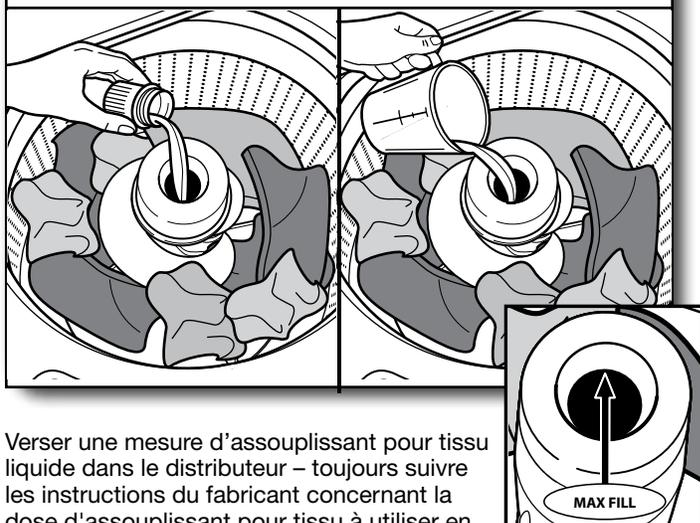
Verser une mesure d'assouplissant pour tissu liquide dans le distributeur – toujours suivre les instructions du fabricant concernant la dose d'assouplissant pour tissu à utiliser en fonction de la taille de la charge.
