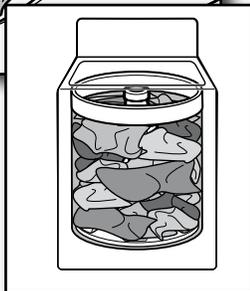
**IMPORTANT :** Ne pas tasser les articles ou les pousser dans la laveuse. Les articles doivent pouvoir se déplacer librement pour un nettoyage optimal et pour réduire le froissement et l'emmêlement.
