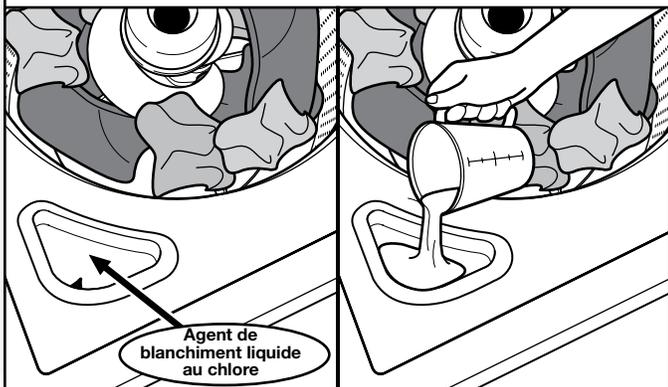
Ne pas remplir excessivement le distributeur ni utiliser plus d'une tasse (250 mL) d'agent de blanchiment liquide au chlore. Ne pas utiliser d'agent de blanchiment sans danger pour les couleurs ni de produit Oxi avec un programme utilisant de l'agent de blanchiment au chlore liquide.
