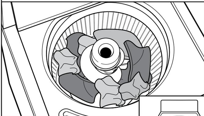
Charger les vêtements sans les tasser et de façon uniforme le long de la paroi du panier. Pour de meilleurs résultats, ne pas remplir au-delà de la hauteur maximale de charge recommandée. Ne pas enrôler de grands articles tels des draps autour de l'agitateur; les charger sans les tasser le long de la paroi du panier. Essayer de mélanger différents types d'articles pour réduire l'emmêlement.
