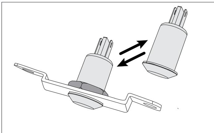
**4** Connectez l'ensemble de la lampe à LED au connecteur d'alimentation et fixez-le au grill avec les deux vis à l'aide d'un tournevis à tête Phillips.
