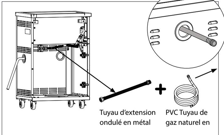
**2** Connectez l'extrémité du tuyau de gaz naturel en PVC à l'alimentation en gaz naturel à l'aide du raccord à connexion rapide.
