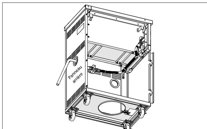
**i** Suivez les étapes 1 à 5 pour connecter le tuyau ondulé en métal et le tuyau de gaz naturel en PVC à l'aide du support de montage, du support en L et de l'adaptateur mâle.
