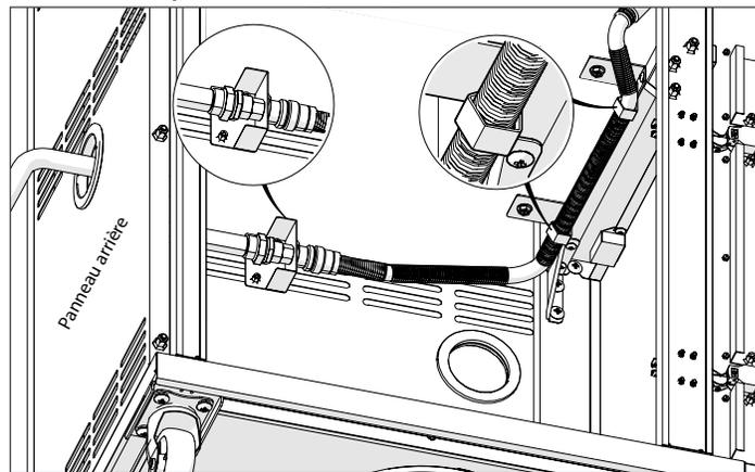
**1** Installez le support de montage sur les fentes d'aération du panneau latéral de l'armoire à l'aide des rondelles et des vis cruciformes fournies.
