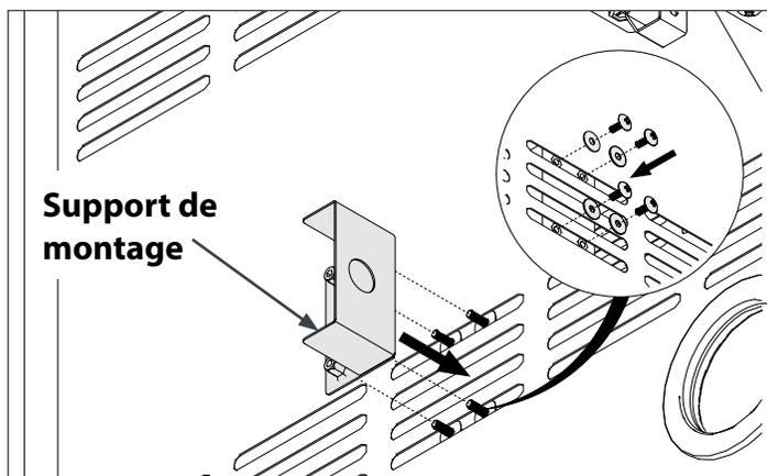
**2** Retirez les vis et utilisez-les pour installer les supports en L.
