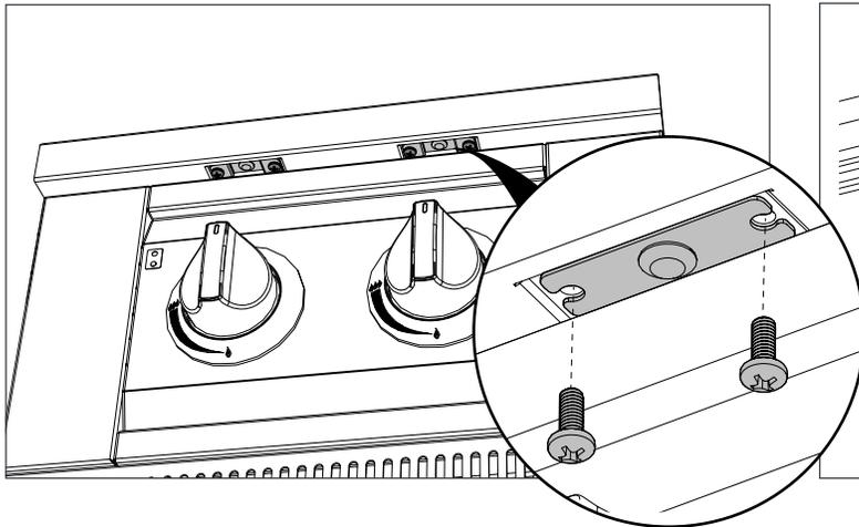
**2** Retirez l'ensemble de la lampe LED et débranchez-la du connecteur d'alimentation.
