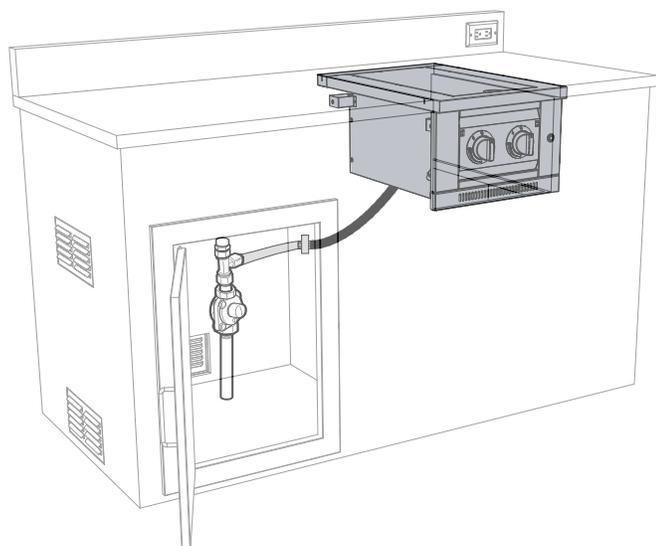
LE TUYAU DOIT AVOIR UN TRAJET EN SERPENT RÉGULIER POUR ÉVITER LES PLIS ET LES DÉFAILLANCES PRÉMATURÉES. VEUILLEZ EXAMINER LES TUYAUX ET LES RACCORDS POUR DÉTECTER LES FISSURES, LES DÉCHIRURES OU LES MARQUES D'USURE DUES AU FROTTEMENT, ETC.
