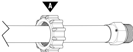
Instale las dos tuercas de unión (**A**) con accesorios en la tubería principal. El roscado de las tuercas de unión debe enfrentar el espaciador.
