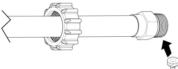
Si se usa adaptadores rosados (como se ilustra), aplique sellador de roscas. **NO** use sellador de roscas en los espaciadores, o el dispositivo Fio futuro. Si se usa adaptadores soldados o conexiones de sección final, déjelos enfriar a temperatura ambiente antes de tocarlos.
