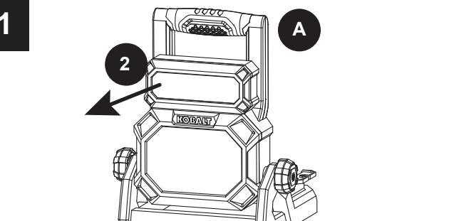
Hold the main light and push (slide) the removable light forward as shown to remove it./Tenez la lampe principale et poussez (faites glisser) la lampe amovible vers l'avant, tel qu'il est illustré, pour la retirer./Sostenga la luz principal y empuje (deslice) la luz desmontable hacia adelante como se muestra para retirarla.
