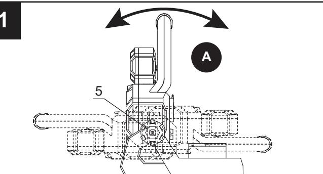
Use the swivel knob to adjust the beam angle./Utilisez le bouton pivotant pour régler l'angle d'éclairage./Use la perilla giratoria para ajustar el ángulo del haz.
