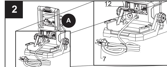
Make sure the master switch is on before using the light. Close the cover when the outlet is not in use./Assurez-vous que l'interrupteur principal est en position de marche avant d'utiliser la lampe. Fermez le couvercle lorsque la prise n'est pas en cours d'utilisation./Asegúrese de que el interruptor principal esté encendido antes de usar la luz. Cierre la cubierta cuando el tomacorriente no esté en uso.
