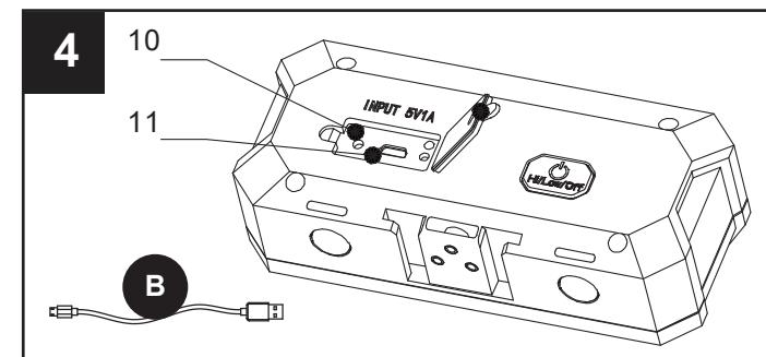
Rechargeable via micro USB port or simply attaching it to the main light./Rechargez-la à l'aide d'un port micro USB ou en la fixant simplement à la lampe principale./Recargable a través del puerto micro USB o simplemente conectándolo a la luz principal.
