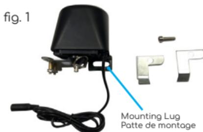
1. Insérer et visser les deux pièces de support à la patte de montage de la valve d'arrêt d'eau. Ne pas serrer les vis complètement afin de faire l'ajustement final lorsque vous ferez l'installation. (fig. 1 et fig. 2)
