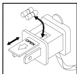
c) Remove fuses carefully./Retire los fusibles cuidadosamente.
