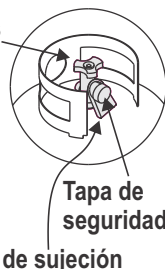
Válvula del tanque de gas
