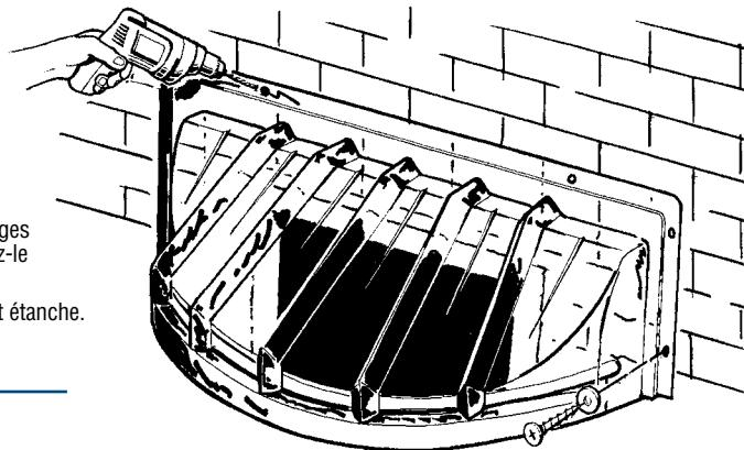
1. Coloque la cubierta sobre el pozo en contra de la pared.
