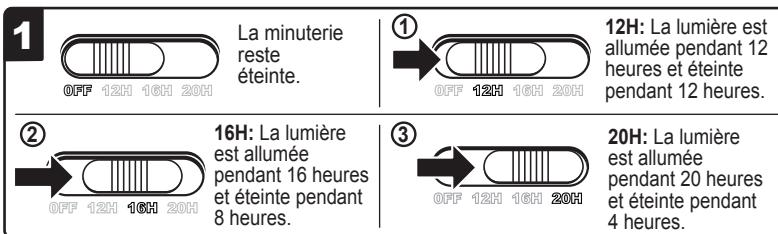
**1** Faites glisser l'interrupteur de la minuterie sur Arrêt/OFF avant d'appuyer sur l'un des boutons poussoirs de couleur (blanc, bleu ou rouge). Lorsque la minuterie est désactivée, allumez et éteignez la lumière manuellement en appuyant sur les boutons poussoirs de couleur.
