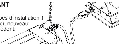
**REMARQUE :** Le cordon de raccordement est conçu pour s'attacher d'une seule façon, et uniquement de cette façon aux luminaires adjacents. Si la fiche ne peut pas être entièrement insérée dans le luminaire, inversez les extrémités du cordon et réessayez. try again.
