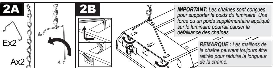
**2A** Déterminez la hauteur à laquelle le luminaire devra être suspendu. Attachez le crochet en « V » (E) à la boucle inférieure de la chaîne (A) en insérant une extrémité du crochet dans la boucle inférieure. Éliminez tous les coude de la chaîne. Suivez la même procédure pour le côté opposé.
