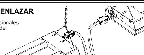
NOTA: El cable de enlace está diseñado para conectarse de una manera y solo de una manera en los accesorios para iluminación adyacentes. Si el enchufe no se puede insertar completamente en el accesorio para iluminación, invierta los extremos del cable e intételo de nuevo.
