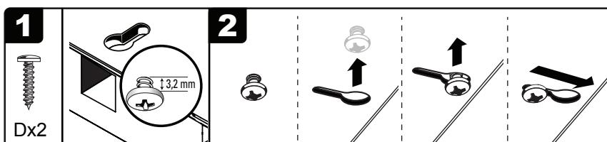
**1** Ajuste los tornillos (D), dejando una holgura de 3,2 mm entre la superficie de montaje y la parte trasera de la cabeza de los tornillos.
