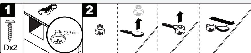
**1** Ajustez les vis (D) en laissant un jeu de 3,2 mm entre la surface de montage et l'arrière de la tête de la vis.
