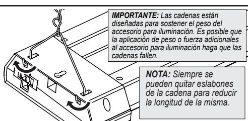
**2A** Determine a qué altura es necesario colgar el accesorio para iluminación. Acople el gancho en "V" (E) en el bucle inferior de la cadena (A) pasando un extremo del gancho a través del bucle inferior. Elimine todos los enredos que haya en la cadena. Repita el procedimiento en el otro lado.
