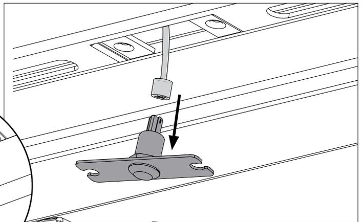
**3** Desserrez le contre-écrou et remplacez l'ampoule LED.
