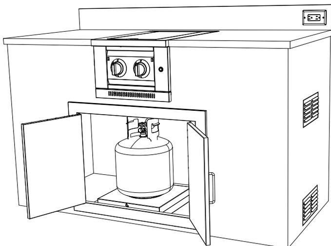
Le réservoir de propane doit être fixé au meuble encastré à l'intérieur de l'enceinte.
