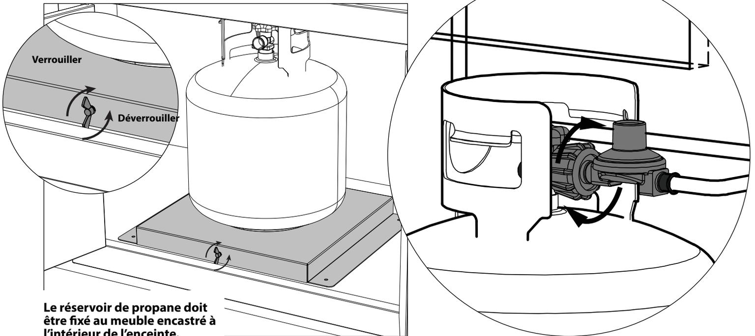
Le réservoir de propane doit être fixé au meuble encastré à l'intérieur de l'enceinte.
