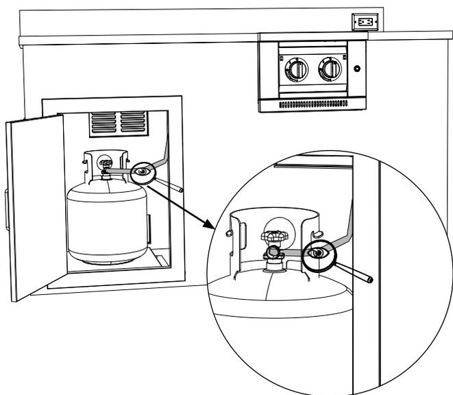
LE TUYAU DOIT AVOIR UN TRAJET EN SERPENT RÉGULIER POUR ÉVITER LES PLIS ET LES DÉFAILLANCES PRÉMATURÉES. VEUILLEZ EXAMINER LES TUYAUX ET LES RACCORDS POUR DÉTECTER LES FISSURES, LES DÉCHIRURES OU LES MARQUES D'USURE DUES AU FROTTEMENT, ETC.
