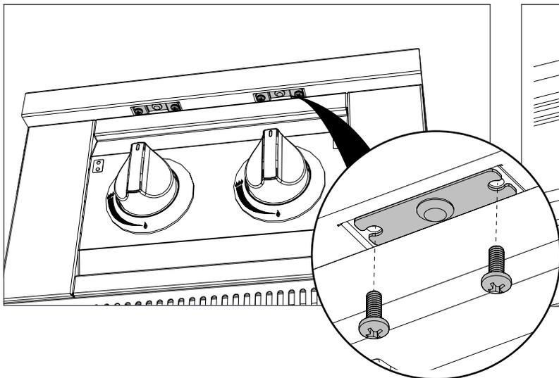
**2** Retirez l'ensemble de la lampe LED et débranchez-la du connecteur d'alimentation.
