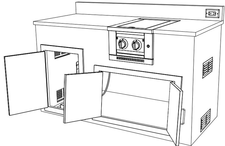
**Le réservoir de propane doit être fixé au meuble encastré à l'intérieur de l'enceinte.**
