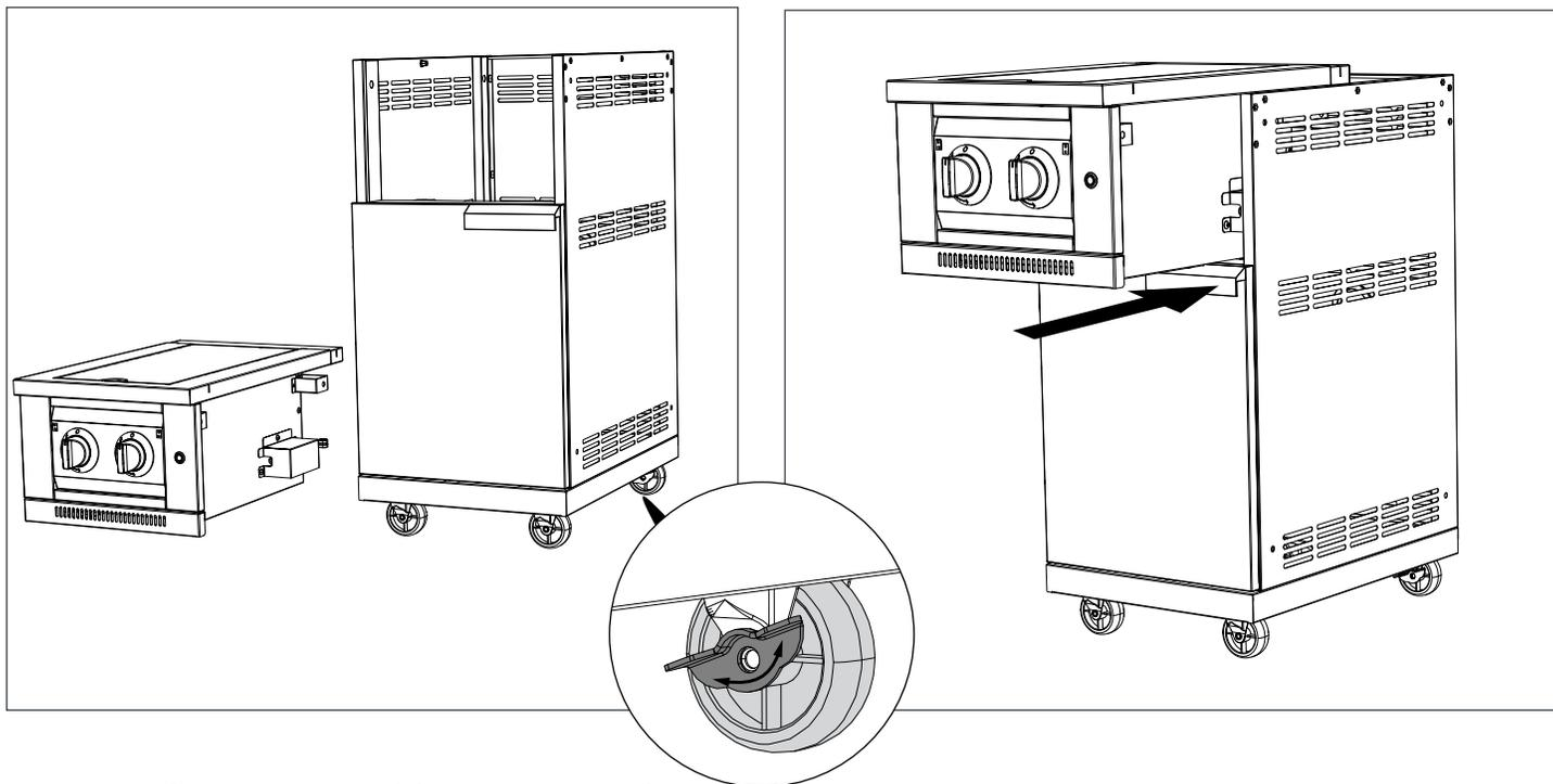
**3** Fixez le DSB au meuble en insérant deux vis M6x45 mm par le bas. Des vis à tête plate sont fournies avec le DSB.
