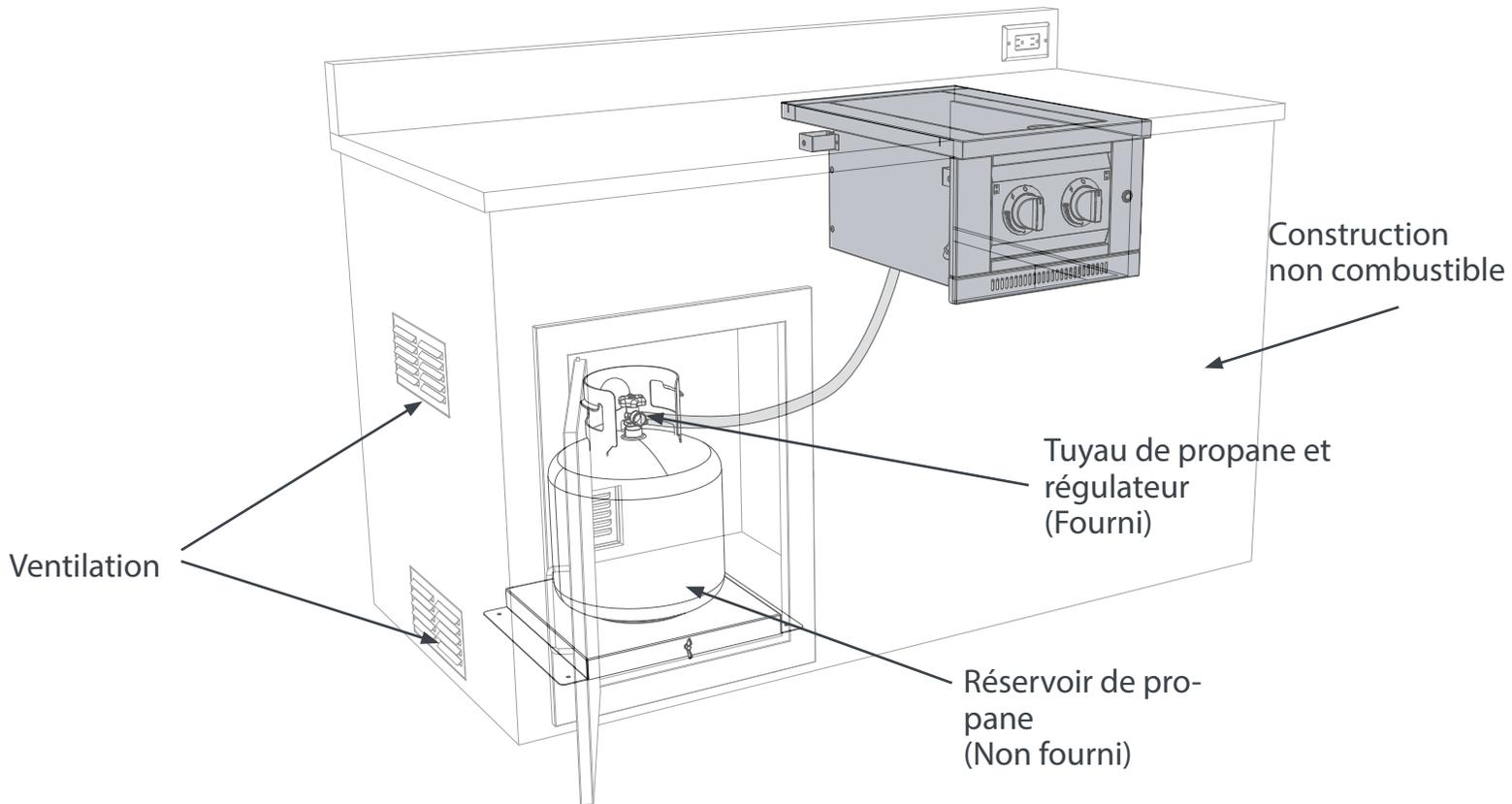
Assurez-vous que le robinet de la bouteille de gaz propane est complètement fermé. Il est possible d'ouvrir le robinet sans libérer de gaz, mais, dès que vous commencez à raccorder le régulateur, du gaz s'échappe de la connexion.
