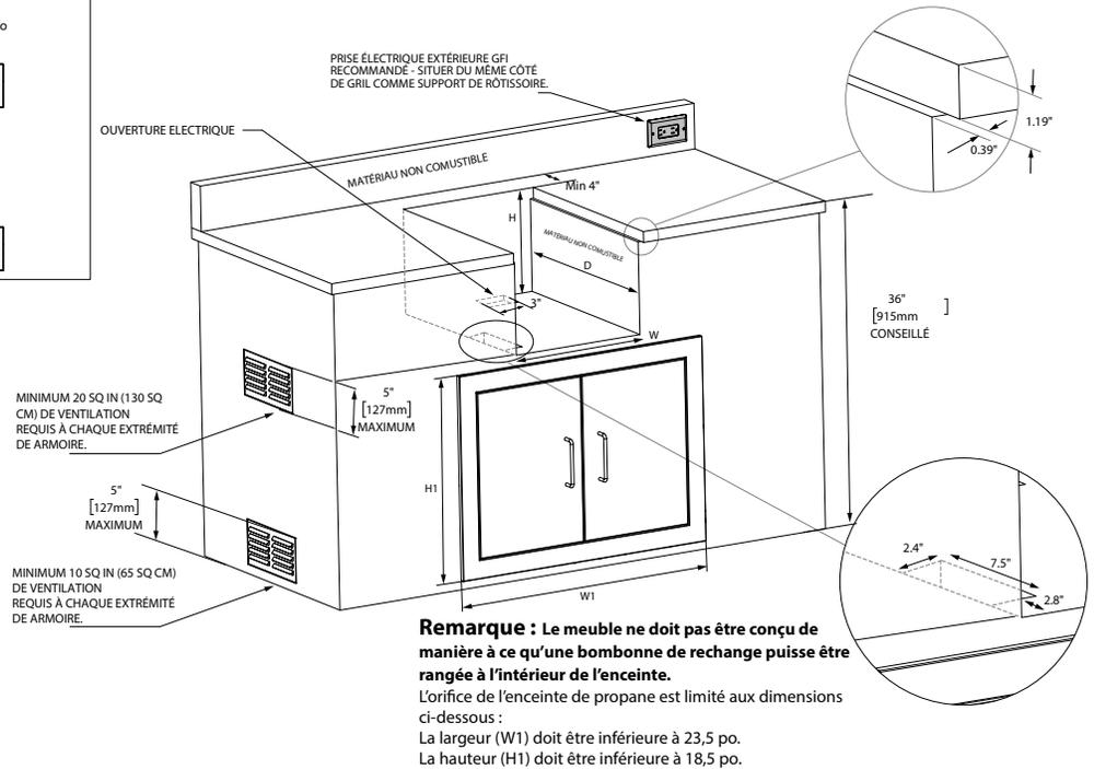
**Remarque :** Le meuble ne doit pas être conçu de manière à ce qu'une bouteille de recharge puisse être rangée à l'intérieur de l'enceinte.
