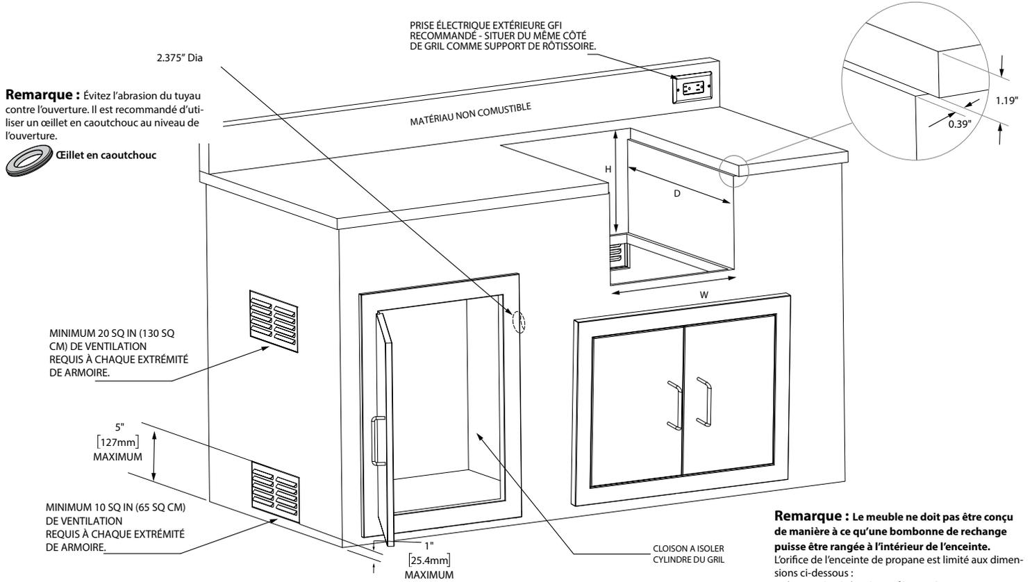
**Remarque :** Le meuble ne doit pas être conçu de manière à ce qu'une bombonne de recharge puisse être rangée à l'intérieur de l'enceinte. L'orifice de l'enceinte de propane est limité aux dimensions ci-dessous : La largeur (W1) doit être inférieure à 23,5 po. La hauteur (H1) doit être inférieure à 18,5 po.
