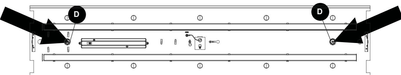
5. ① Inserte las cabezas de los tornillos de la caja (BB) en los extremos redondos grandes de las ranuras tipo cerradura. ② Deslice el ensamble hasta que las cabezas de los tornillos (BB) queden completamente capturadas por la parte estrecha de las ranuras tipo cerradura. Gire el ensamble para alinearlo con la pared elegida, mientras mantiene ambos tornillos de la caja (BB) enganchados en la ranura estrecha.
