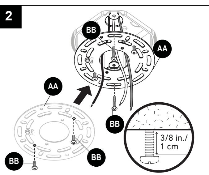
2a. \* Pour les boîtes de sortie mises à la terre SANS fil de mise à la terre, retirez la vis de mise à la terre (verte) du support de fixation (AA). Fixez le fil de mise à la terre (DD) inclus en insérant la vis de mise à la terre dans l'œillet fixé au fil de mise à la terre (DD). Revissez la vis de mise à la terre sur le support de fixation (AA). Insérez le support de fixation (AA) dans la boîte de sortie.
