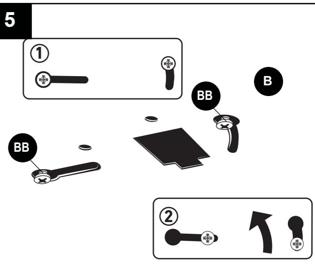
6. Une fois que les deux vis (BB) sont complètement insérées dans les parties étroites de l'encoche, manœuvrez le luminaire dans la position souhaitée et serrez les vis (BB). ÉVITEZ DE SERRER EXCESSIVEMENT.
