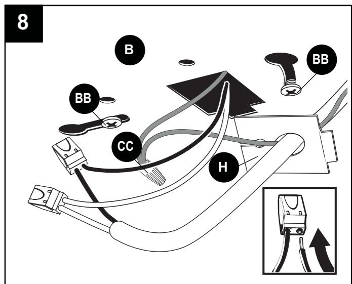
9. Empuje todos los conectores y el exceso de conductores hacia la caja eléctrica y vuelva a colocar la cubierta del conductor (H).
