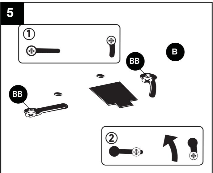
6. Una vez que ambos tornillos (BB) estén completamente enganchados en las canaletas estrechas de la ranura, maniobre el ensamble hasta dejarlo en la posición deseada y apriete los tornillos (BB). NO APRIETE DEMASIADO.
