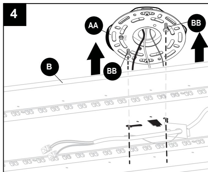
5. ① Insérez les têtes de vis pour boîte de sortie (BB) dans les grandes extrémités arrondies des encoches en trou de serrure. ② Faites glisser le luminaire jusqu'à ce que les têtes de vis (BB) soient entièrement insérées dans la partie étroite des encoches en trou de serrure. Faites pivoter le luminaire de façon à l'aligner sur le mur choisi, tout en maintenant les deux vis pour boîte de sortie (BB) insérées dans la fente étroite.
