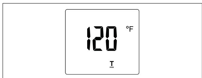
Au menu de réglage de T<sub>max</sub>, l'afficheur clignote, indiquant que la valeur peut être modifiée en tournant le bouton de réglage. La valeur de T<sub>max</sub> peut être augmentée en tournant le bouton de réglage dans le sens horaire et diminuée en le tournant dans le sens antihoraire. La valeur de T<sub>max</sub> peut être désactivée en tournant le bouton de réglage dans le sens antihoraire au-delà du réglage.
