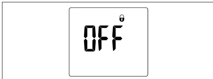
Si el parámetro de bloqueo de la pantalla está configurado en "On" y el usuario sostiene el botón de  $T_{max}$  por 5 segundos o deja que la pantalla quede en pausa por 15 segundos, el bloqueo de la pantalla se activará.
