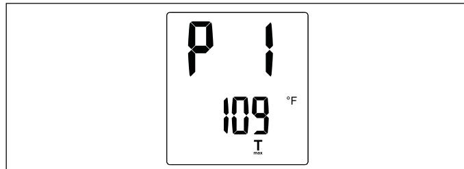
En el menú de ajuste de  $T_{max}$ , la pantalla parpadea, lo que indica que se puede cambiar el valor girando la perilla de control. El valor  $T_{max}$  puede aumentarse girando la perilla de control hacia la derecha y disminuirse girándola hacia la izquierda. El valor  $T_{max}$  puede desactivarse al girar la perilla de control hacia la izquierda, pasando la opción de 20 °C (68 °F). En la pantalla se indicará "Off" si el valor  $T_{max}$  está inactivo.
