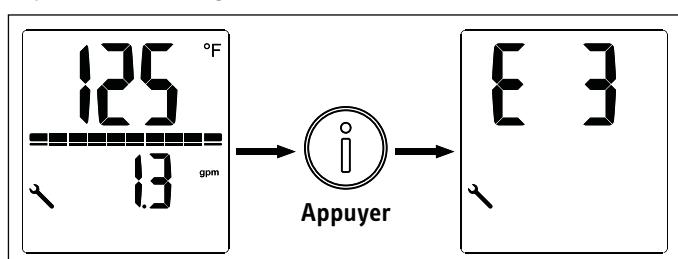
Lorsque la clé est affichée, appuyez sur le bouton Information pour afficher la page d'affichage des erreurs. Consultez la section « 5.3.6 Menu d'erreurs du Tempra Plus » à la page 50 pour plus de détails pour interpréter le code d'erreur signalé.
