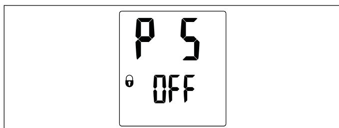
Si le paramètre du blocage de l'afficheur est réglé sur « On », et si l'utilisateur maintient le bouton Informations enfoncé pendant 5 secondes ou attend 15 secondes que l'afficheur se mette en veille, le blocage de l'afficheur est activé.
