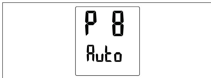
La pantalla en su totalidad y la retroiluminación comenzarán a parpadear, con el fin de indicar que el valor puede modificarse girando la perilla de control. Cuando el valor está ajustado en "Auto", se desactivará automáticamente después de 15 segundos de inactividad.
