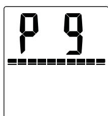
La barre d'état de la capacité d'alimentation indique le réglage de luminosité. Une barre de capacité complète indique que la luminosité est réglée sur « haut ». Une barre de capacité à moitié indique que la luminosité est réglée sur « bas ».
