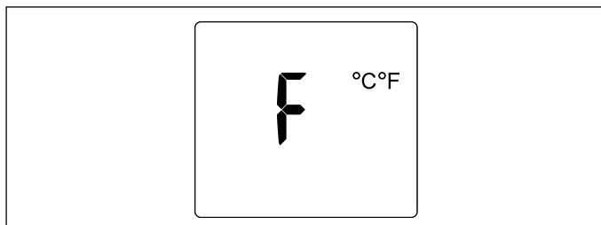
Se visualiza la unidad actual y la pantalla entera parpadea con el fin de indicar que el valor puede ser modificado. Para cambiar el valor de Fahrenheit a Celsius y viceversa, debe girarse la perilla de control.
