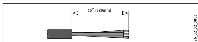
El cable debe pasarse a través de los orificios ciegos ubicados entre las conexiones de agua caliente y de agua fría (vea la sección 9.1, pág. 33). Los cables energizados deben conectarse a las ranuras del bloque de terminales y marcarse como L1 y L2. El
