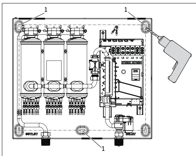
1 Orificios de montaje
