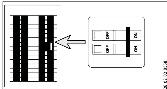
**Tempra 12 Trend / Plus:** Ces appareils peuvent être connectés à un circuit simple. Utilisez un câble d'alimentation protégé par un disjoncteur bipolaire.
