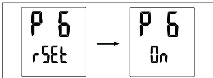
Tout l'affichage clignotera pour indiquer que la valeur peut être modifiée en tournant le bouton de réglage. Lorsque la valeur est réglée sur « On », la réinitialisation doit être confirmée en maintenant le Bouton 1 et le Bouton 2 enfoncés simultanément pendant 5 secondes.
