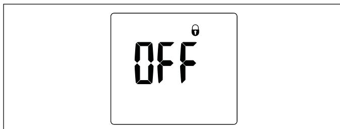
Si le paramètre du blocage de l'afficheur est réglé sur « On », et si l'utilisateur maintient le bouton T<sub>max</sub> enfoncé pendant 5 secondes ou attend 15 secondes que l'afficheur se mette en veille, le blocage de l'afficheur est activé.
