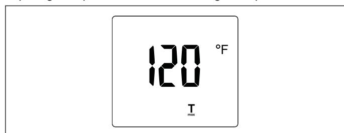
En el menú de ajuste  $T_{max}$ , la pantalla comienza a parpadear, lo que indica que el valor puede modificarse girando la perilla de control. El valor  $T_{max}$  puede aumentarse girando la perilla de control hacia la derecha, y disminuirse girándola hacia la izquierda. El valor  $T_{max}$  puede desactivarse al girar la perilla de control hacia la izquierda, pasando el ajuste de 20 °C (68 °F). En la pantalla se indicará "Off" si el valor  $T_{max}$  está inactivo.
