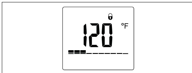
Avec le blocage de l'afficheur activé, un cadenas s'affiche sur l'écran d'accueil et aucun paramètre ne peut être changé. Pour désactiver le blocage, maintenez le bouton T<sub>max</sub> enfoncé pendant 12 secondes. Le cadenas disparaîtra de l'afficheur et il sera à nouveau possible de changer les paramètres.
