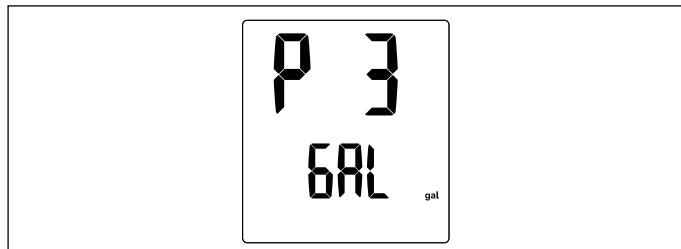
L'unité de volume utilisée à l'instant sera affichée et la valeur clignotera pour indiquer qu'elle peut être changée. Faites tourner le bouton de réglage pour basculer entre gallons par minute et litres par minute.
