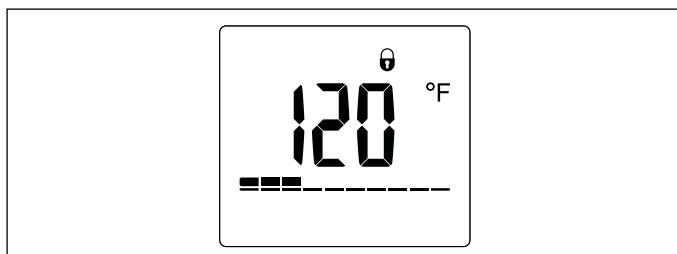
Cuando el bloqueo de la pantalla está activo, aparece un ícono de candado en la pantalla principal y no se puede modificar ningún parámetro. Para desactivar el bloqueo, sostener el botón de  $T_{max}$  por 12 segundos. De esa manera, desaparecerá el ícono de candado de la pantalla y se podrán volver a modificar todos los parámetros.
