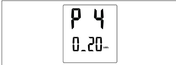
La pantalla secundaria parpadea para indicar que el valor puede modificarse girando la perilla de control. Revise su factura de electricidad para calcular el costo de electricidad.
