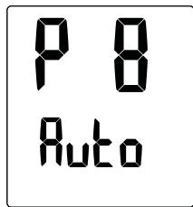
Tout l'affichage et le rétroéclairage clignoteront pour indiquer que la valeur peut être modifiée en tournant le bouton de réglage. Lorsque la valeur est réglée sur « On », le rétroéclairage restera allumé. Lorsque la valeur est réglée sur « Auto », il s'éteindra automatiquement au bout de 15 secondes sans activité.
