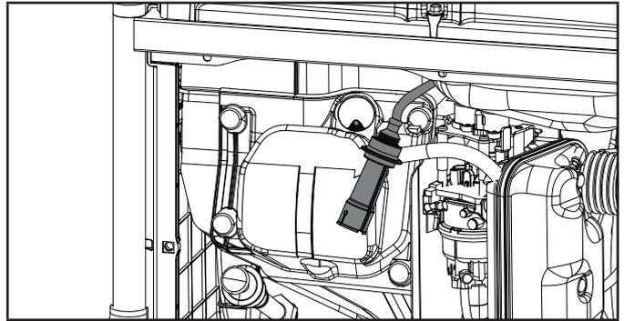
3. Use una herramienta para bujías (incluido), o un dado de 13/16 in. (21 mm) (no incluido) para remover la bujía.
