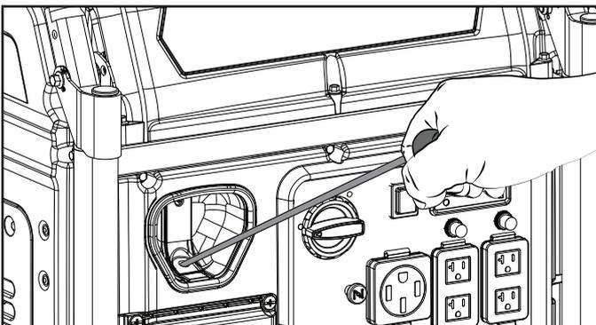
9. Si el motor no arranca en 1 jalón con el ahogador en la posición "CORRER", entonces jale el ahogador a la posición "AHOGAR" y repita el paso Jale-para-Cebar. Tan pronto como arranque el motor, oprima el ahogador a la posición "CORRER".
