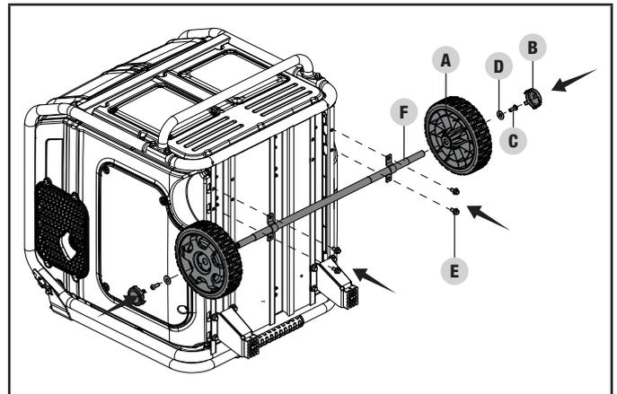
6. Inclíne levemente el generador para que descance sobre las ruedas y la pata de apoyo.
