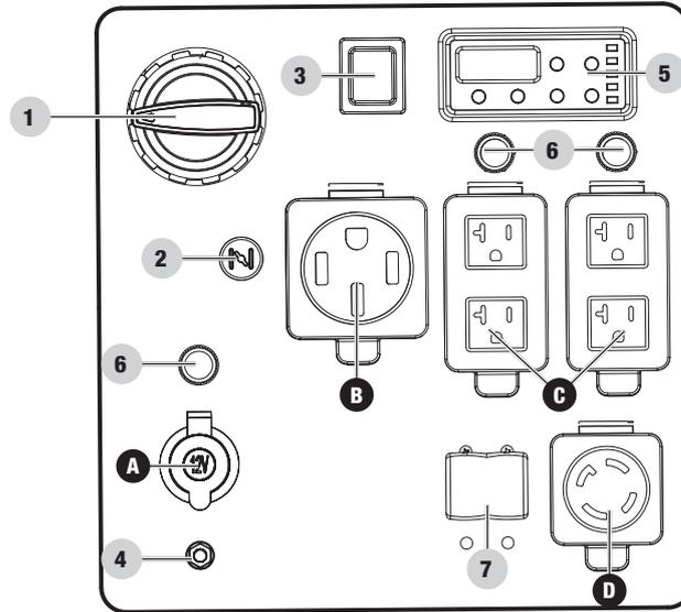
1. **Dial selector de combustible** – Utilizado para seleccionar y activar la fuente de combustible de gasolina o propano (GLP).
