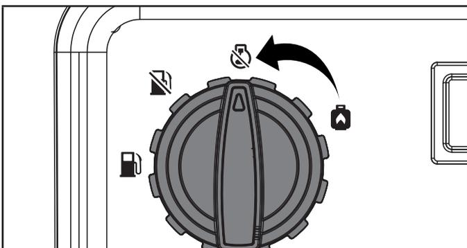
**Importante:** Siempre asegúrese de que el dial selector de combustible este siempre en posición "APAGADO" cuando el generador no esté en funcionamiento.
