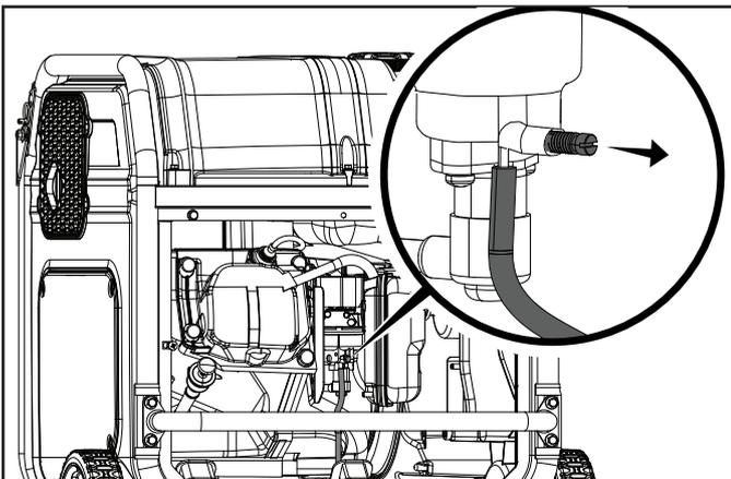
5. Cuando la gasolina pare de fluir, gire el tornillo de drenaje a reloj (derecha) hasta que se apriete. Deshágase de la gasolina drenada en acuerdo con las regulaciones y normas locales.
