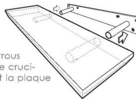
Utilizando un taladro eléctrico y una broca de 9/32 pulg., taladre el agujero en las marcas de la pared. Utilizando un taladro eléctrico o desarmador (para los tornillos con cabeza Phillips), atornille los tronillos provistos dentro de los montantes (o anclajes), asegurando la placa posterior a la pared.
