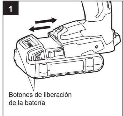
**AVISO:** cuando coloque el paquete de baterías en la herramienta, asegúrese de que la varilla elevada del paquete de baterías se alinee con la ranura de la herramienta y que los pestillos encajen en su lugar de manera correcta. El ensamblaje inadecuado del paquete de baterías puede provocar daños a los componentes internos.
