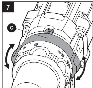
**AVISO:** no cambie la configuración de modo mientras la herramienta esté en funcionamiento.
