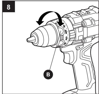
**AVISO:** no cambie la configuración de torsión mientras la herramienta está en funcionamiento.
