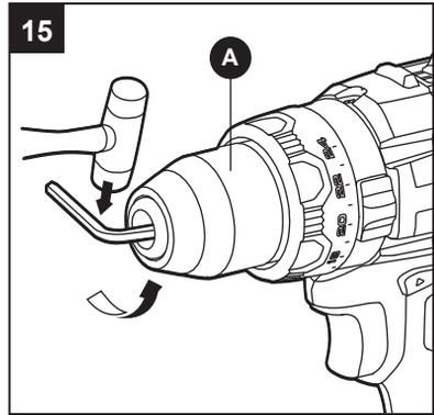
**AVISO:** el tornillo del mandril tiene roscas hacia la izquierda. Fije un mandril nuevo al eje y apriete el tornillo del mandril.
