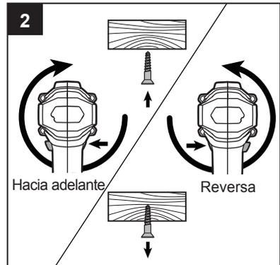
**AVISO:** para evitar que los engranajes se dañen, siempre deje que el taladro percutor se detenga por completo antes de cambiar la dirección de la rotación.
