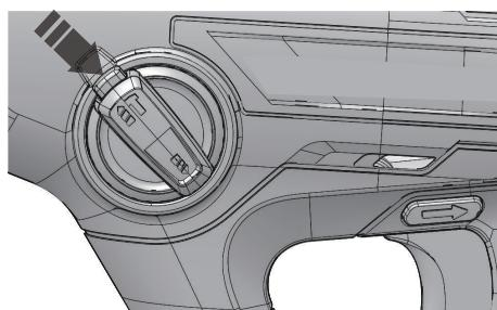
Pour changer le mode de fonctionnement, appuyez sur le bouton de déclenchement et tournez le sélecteur de mode à la position correcte jusqu'à ce que vous entendiez un clic d'enclenchement.
