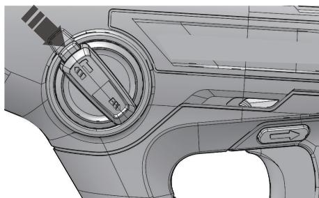
Para cambiar el modo de funcionamiento, pulse el botón de desbloqueo y gire el interruptor de selección de modo a la posición correcta hasta que encaje.
