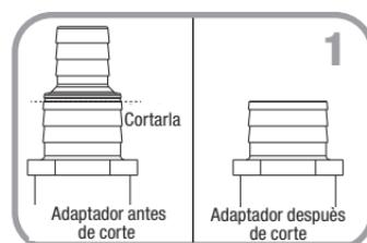
**Paso 1.** Si utiliza el tamaño de tubería más grande recomendado para su bomba, recorte el adaptador de la tubería usando una sierra para metales en la ubicación indicada.
