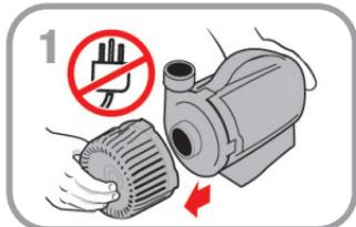
**Étape 2.** Retirez le couvercle de la turbine pour exposer l'ensemble de la turbine.
