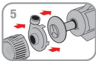
**Étape 5.** Remontez toutes les pièces de la pompe, placez la pompe à l'intérieur de la pumphield® et placez-les dans l'eau avant de vous reconnecter à la source d'énergie.
