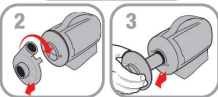
**Étape 3.** Retirez l'ensemble de la turbine en tirant doucement sur les pales de la turbine. La turbine est maintenue en place par un aimant. REMARQUE: Cette pompe utilise un aimant très fort. Pour protéger vos doigts contre les blessures, faites preuve de prudence lorsque vous retirez ou insérez la turbine.
