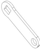
F04 LINKAGE STRAP - A4M02225 (x2) 1/8"x13/16"x2 5/8" (3x20x66)
