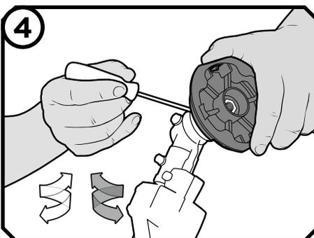
Asegúrese de que haya un cierre indicado en el agujero de la tuerca del cabezal y atornille en el eje.
