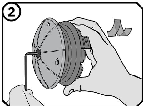
Con el perno y el soporte, instale el deslizador ajustándolo con una llave Allen. Ajuste a mano a 40 pies-libras de fuerza en el sentido opuesto de las manecillas del reloj.
