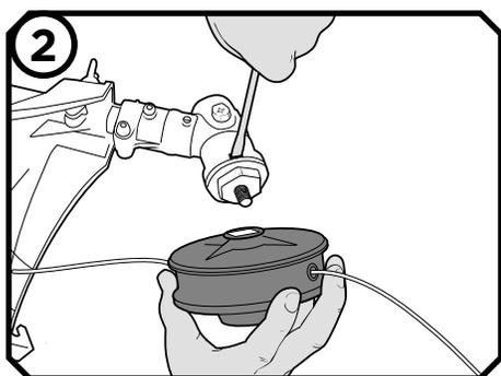
Las cabezas de eje corto se desmontan en una sola pieza
