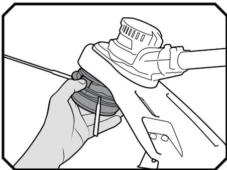
Para retirar la cubierta, apriete las lengüetas con los dedos y tire (ayúdese con un destornillador de ser necesario).
