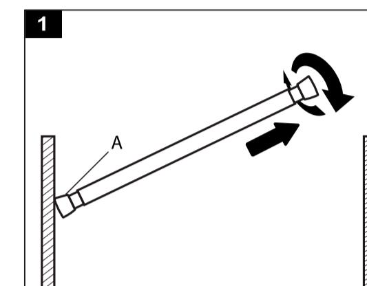
**2 Installing the rod/Installation de la tringle/Instalación de la varilla**
