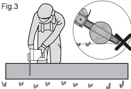
Tronco apoyado en un extremo, Haga el primer corte del lado inferior del tronco, atravesie 1/3 del diámetro del tronco (1). Este corte impedirá la producción de astillas en esta sección al completarse el corte (2). (Figura. 4)
