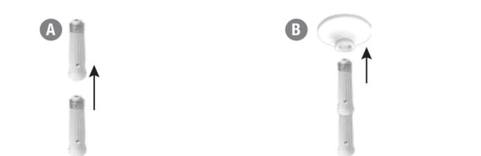
Connectez les deux extensions de douille ensemble et vissez dans le sens horaire pour les serrer.
