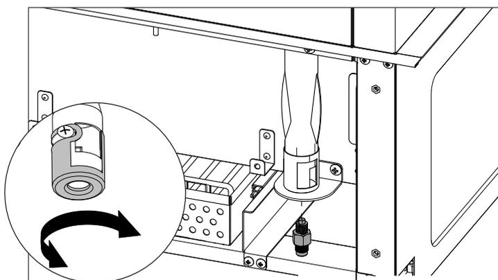
Suivez la procédure indiquée dans l'ordre inverse de l'étape 4 à l'étape 1 pour réinstaller le brûleur arrière et le panneau arrière.
