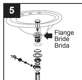
Applique une goutte de scellant (non inclus) sous la partie inférieure de la bride d'évacuation pour former un joint étanche entre le lavabo (A) et le tuyau d'évacuation. Nettoyez tout excédent de scellant après avoir installé le tuyau d'évacuation sur le lavabo (A).
