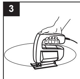
Siguiendo la línea de perímetro de la plantilla (B), corte una abertura para el lavabo (A) en la cubierta prefabricada.
