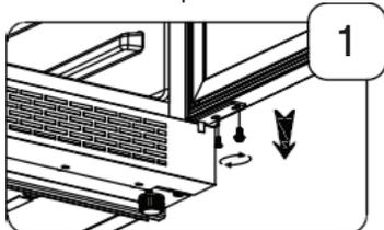
1. Ouvrez la porte et à l'aide d'un tournevis cruciforme, retirez les vis inférieures de la charnière inférieure.
