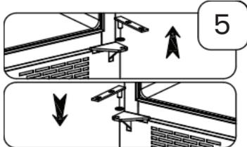
5. Retirez l'axe de la porte de la charnière inférieure droite. Installez l'axe de porte sur la charnière inférieure gauche.
