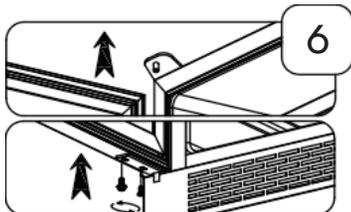
6. Insérez délicatement la porte dans la charnière supérieure gauche, puis faites glisser la porte sur le dessus de la charnière inférieure et fixez la porte en installant les vis inférieures.
