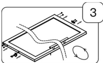
3. La porte tourne à 180 degrés. Retirez l'aimant de porte et installez-le du côté opposé. Retirez le couvercle en plastique argenté de la charnière supérieure de la porte.
