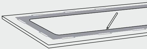
2. Corte la cubierta prefabricada con las herramientas de corte adecuadas. Cortar en la línea dará como resultado una instalación al ras. Ajuste la línea según corresponda si desea una revelación positiva o negativa. Si utiliza una máquina CNC, descargue el archivo DXF de [www.lowes.com](http://www.lowes.com) y proceda en consecuencia.
