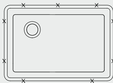
3. Coloque el fregadero boca abajo. Alinee el fregadero con la línea de corte en la cubierta prefabricada. Con un lápiz, marque 8 puntos alrededor del reborde a una distancia de aproximadamente 19.05 mm a 2.54 cm del borde del fregadero. Para obtener una instalación firme, se recomienda que se utilicen todos los sujetadores de montaje incluidos.
