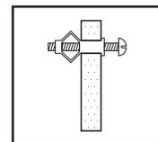
**CONCRETE WALL:** Drill 1/4 in. holes, insert #12 wall anchors and secure to wall with #12 x 3 in. screws./**MUR DE BÉTON:** Percez des trous d'un diamètre de 6,35 mm, insérez-y des chevilles d'ancrage no 12, puis fixez l'armoire au mur à l'aide de vis no 12 de 3 po./**PARED DE CONCRETO:** Taladre orificios de 1/4 pulg, coloque anclas de expansión # 12 y fije a la pared con tornillos # 12 x 3 pulg.
