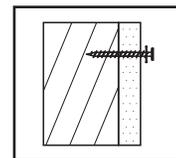
**DRY WALL:** Drill holes and secure to the wall with toggle bolts and a washer./**CLOISON SÈCHE:** Percez les trous et fixez l'armoire au mur à l'aide de boulons à ailettes et de rondelles./**PANEL DE YESO:** Taladre orificios y fije a la pared con tornillos de fiador y arandelas.
